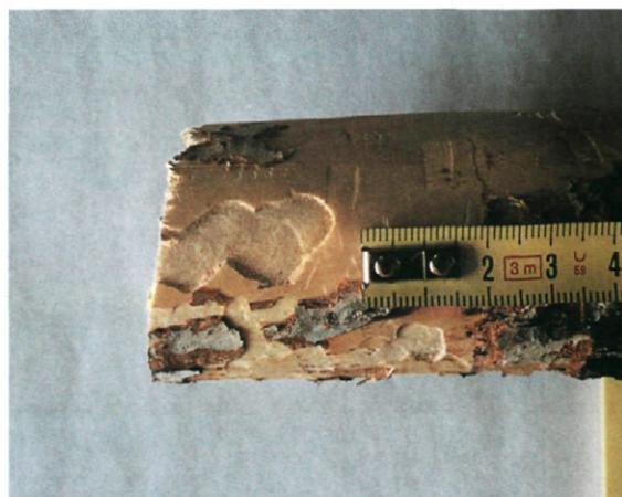
dos por las larvas del primer año, pequeñas galerías y manchas necróticas, las larvas de segundo año llegan a excavar galerías de más de un centímetro de ancho y que rodean completamente los troncos (Figs. 5 y 6).
