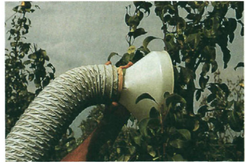
Fig. 10.-Muestreo en frutales (perales) con cono de succión.
