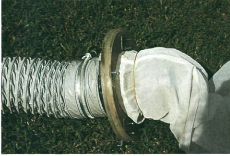
Fig. 5.-Tapadera del cilindro. En la parte anterior lleva acoplada el tubo flexible. En la posterior, la bolsa de muselina.
