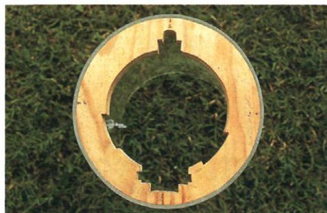
Fig. 4.—Aro de madera para acoplar el tubo cilíndrico a la parte anterior del motor.
