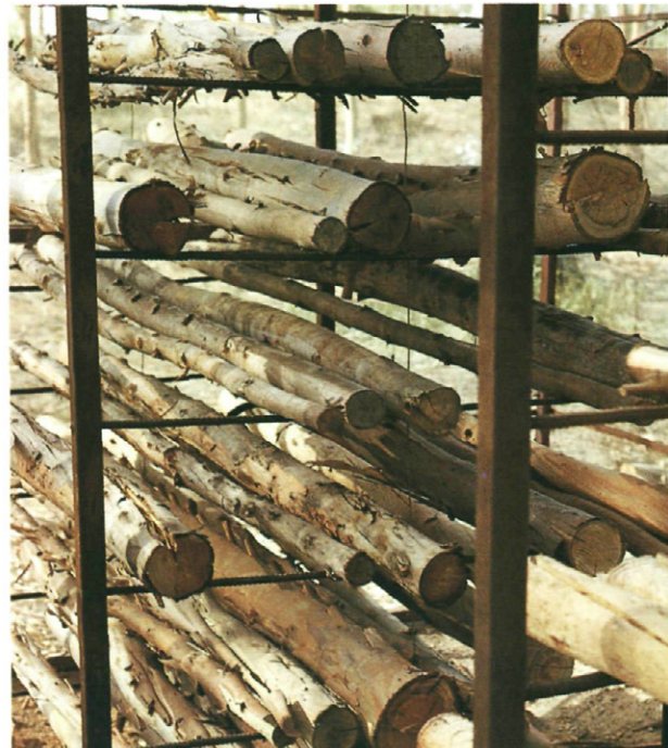
Fig. 2.—Detalle del jaulón, con las estructuras metálicas soportando las trozas.
