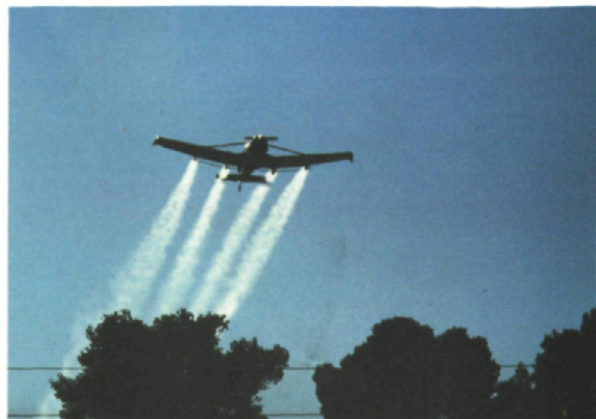
Fig. 1.—Aplicación aérea en la parcela de Sabadell. Avioneta Cessna 300 Ag Wagon equipada con 4 atomizadores Micronair AU 3000.
