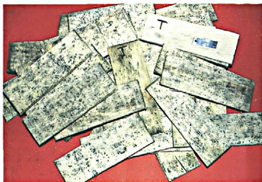
Fig. 3.—Aspecto de las tablillas testigo sin tratar, al cabo de dos meses.
