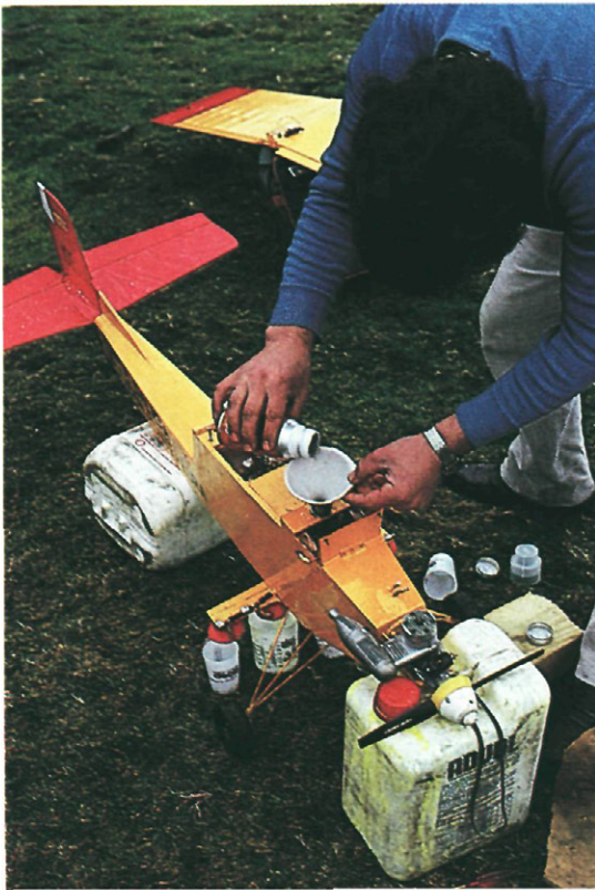
Fig. 4.—Carga del depósito. (Foto P. MANSILLA).
