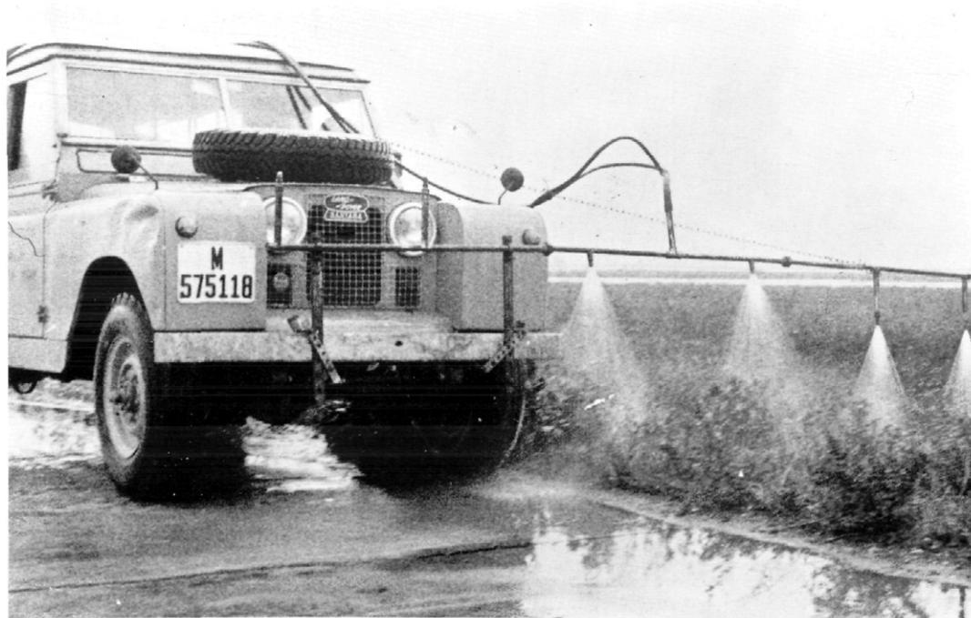
Figs. 23 y 24.—Equipos de aplicación utilizados para el control de hierbas en autopistas, carreteras y bandas de balizaje de aeropuertos.
