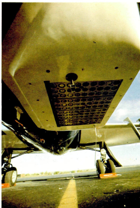
Fig. 11. (B) Panza de un Lear Jet mostrando las cestas llenas de cartuchos de ioduro potásico. (Foto J. Aragónés).
