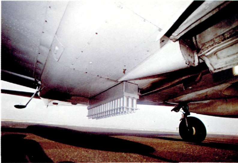
Fig. 13. (D) Carga de cartuchos montados en la panza de un Piper Azteca Turbo. (Foto J. Aragónés).
