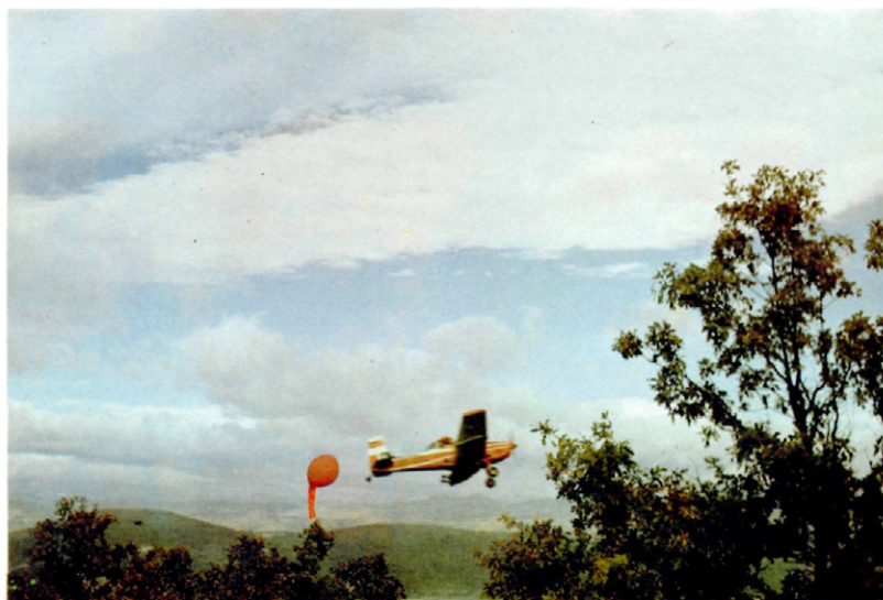
Fig. 3. Cessna Ag-wagon al final de la pasada en un tratamiento con la técnica ULV. Obsérvese el globo de señalización de pasadas. (Foto Archivo Servicio Defensa contra Plagas).
