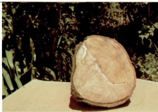
Fig. 6.—Sección de madera de abedul presentando pudrición primática causada por Piptoporus betulinus .
