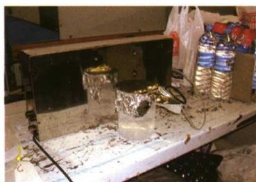
**Equipo generador de ozono (3 g/h) y detalle de la generación de ozono en la suspensión de esporas fúngicas a través del microdifusor.**
