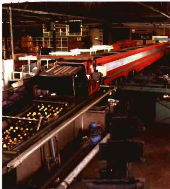
La seleccionadora Calistar, con una capacidad de por lo menos ocho toneladas métricas por hora, está provista de pinzas que transportan la fruta a lo largo del proceso, evitando caídas de la misma que la dañen. (Foto Aweta).
