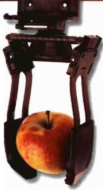
La seleccionadora Calistar, con una capacidad de por lo menos ocho toneladas métricas por hora, está provista de pinzas que transportan la fruta a lo largo del proceso, evitando caídas de la misma que la dañen. (Foto Aweta).
