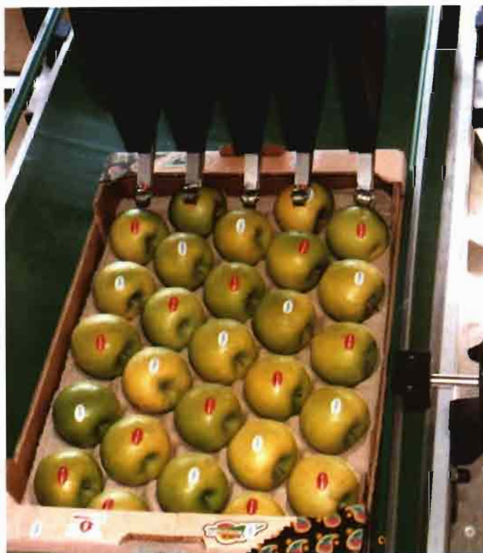
Arriba, caja de melocotones etiquetados mediante etiquetadora manual de Dix & Sons. Debajo, etiquetadora automática Tapiz Ta 100 de la empresa Euro-label. En la imagen inferior, etiquetaje de frutas por bandejas mediante etiquetadora automática de Euro-Stic, con una capacidad de 800 bandejas/hora
