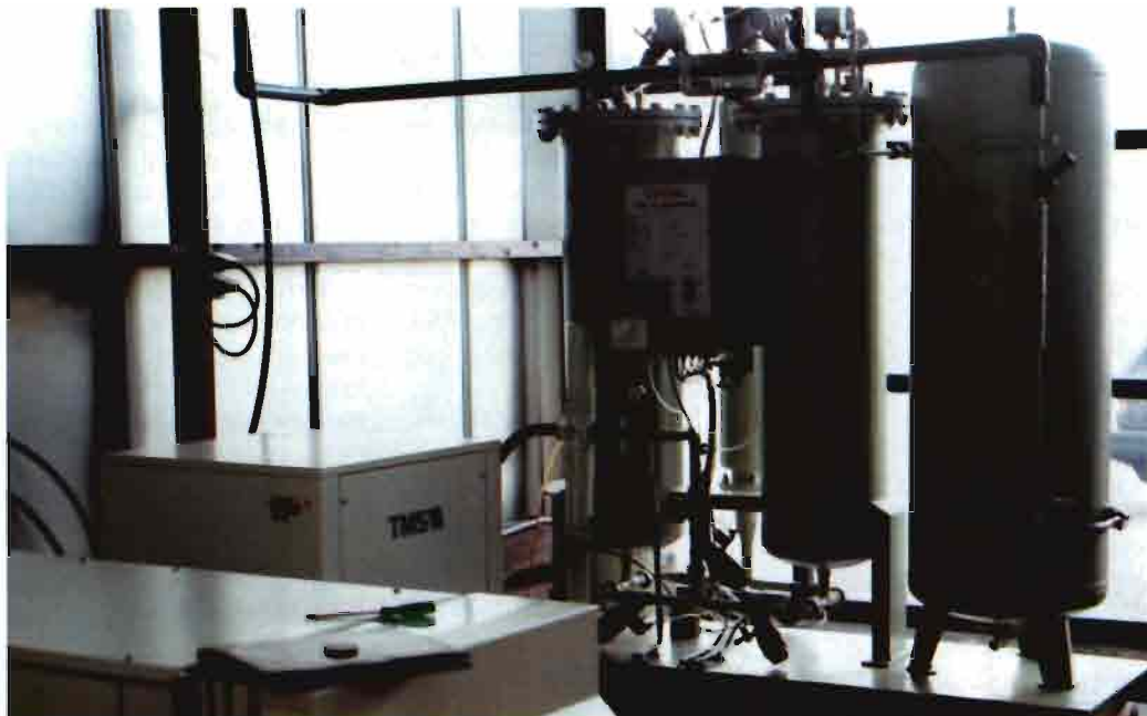
En la fotografía superior, equipo PSA para la generación de atmósferas controladas en almacenes de fruta. Una de las principales acciones beneficiosas de las técnicas LO y ULO es el control del «escaldado superficial» en algunas variedades de manzana, como muestra la fotografía inferior
