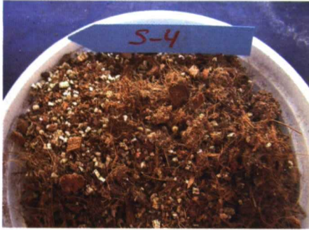
Sustrato M4 (10:3:7; v:v:v) con fibra de coco B (80% fibra y 20% chips), turba y vermiculita.
