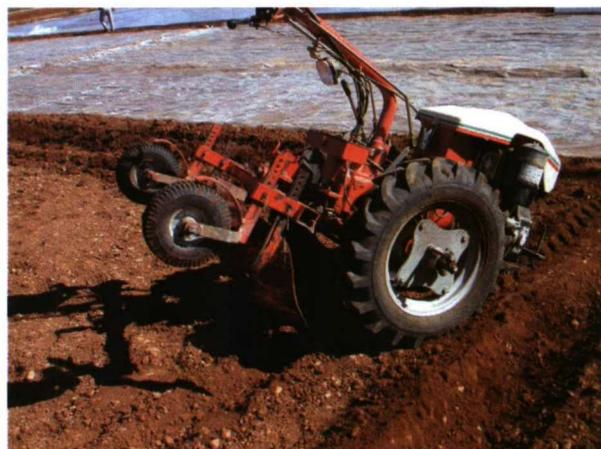
**Máquina para abrir surcos y después tapar bordes como ayuda a la colocación del plástico de solarización.**
