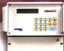
El controlador más vendido para la fertirrigación, con modelos de 6 a 26 salidas configurables para sectores de riego, 1 motor, 4 fertilizantes, 4 agitadores, 1 inyectora y 9 filtros, más 5 entradas de señales. Actuaciones por tiempo y volumen.
