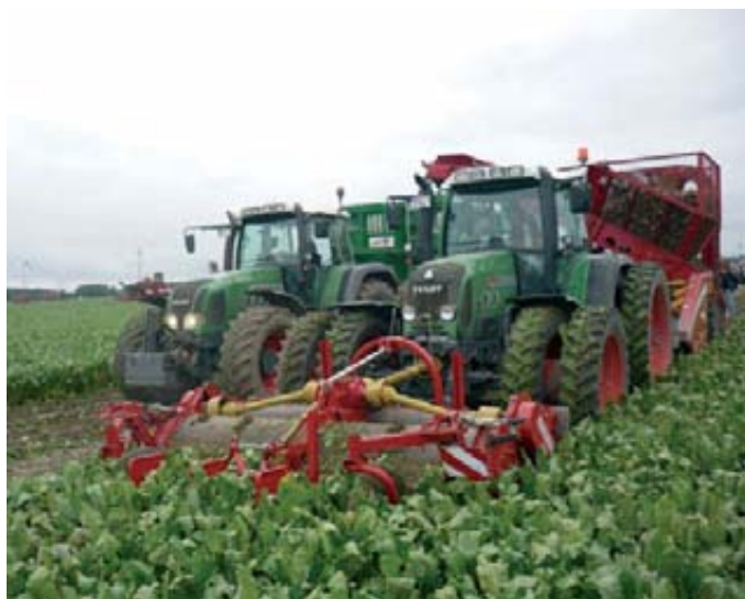
Foto izda. Equipo de recolección descompuesto con arranque y acordonado. Foto dcha. Equipo de recolección descompuesto con arranque y carga.
