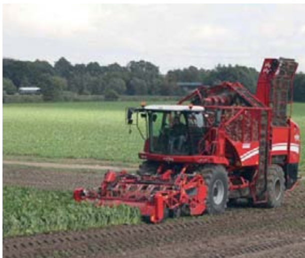
Foto izda. Cosechadora integral que realiza en una pasada el descoronado, arranque, limpieza y carga de la remolacha. Foto drcha. Descoronado óptimo, con eliminación de todas las hojas pero respetando la altura del corte sobre la raíz.
