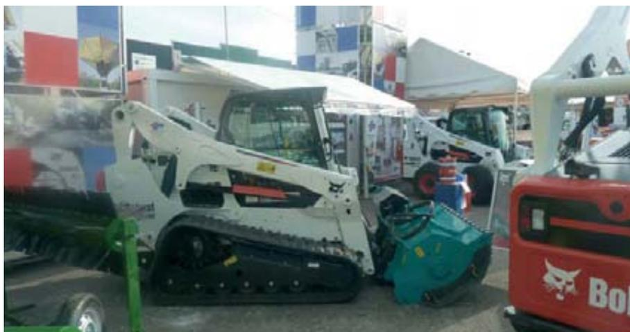
Foto 16. Picadora sobre cargadora compacta.
