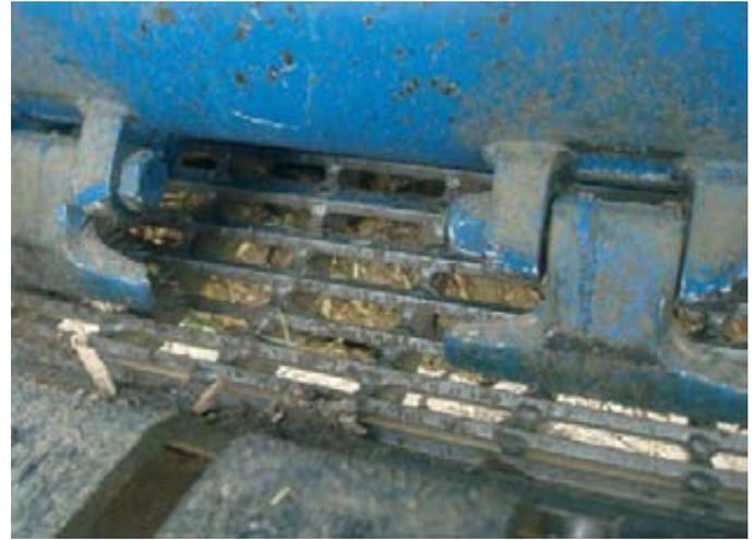
Foto 12 (izda.). Sistema de alimentación: dos rodillos horizontales y un rodillo vertical. Foto 13 (dcha.). Detalle de martillos y parilla inferior.
