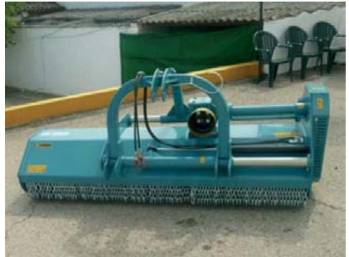
Foto 14 (izda.). Picadora autoalimentada con parrilla trasera. Foto 15 (dcha.). Picadora con sistema para desplazamiento lateral.
