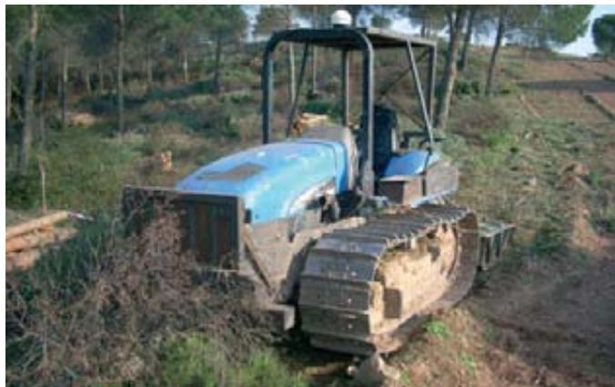
Foto 10. Tractor de cadenas dispuesto a repasar un área cortafuegos con desbrozadora.
