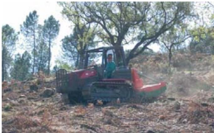
Foto 9. Tractor de cadenas adaptado al medio forestal desbrozando bajo arbolado.
