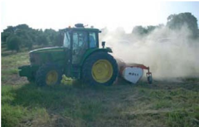
Foto 6. Tractor de neumáticos con picadora.
