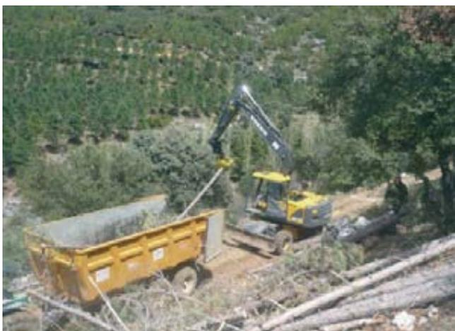
Foto 7. Tractor de neumáticos con remolque agrícola en transporte de residuos de aclarado para biomasa.
