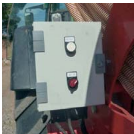
Foto 12. Sistema electrónico para calibración de la dosis de siembra (kg/ha).
