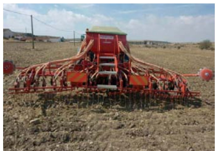
Foto 7. Rastras de púas independientes en la parte posterior de la sembradora.
