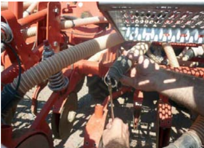
Foto 10. Medición de la velocidad de aire en los cuerpos de siembra con un anemómetro de hilo caliente.
