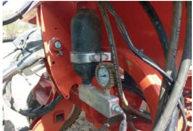
Foto 9. Calderín de nitrógeno para facilitar el seguimiento del contorno del terreno en los cuerpos laterales de siembra.
