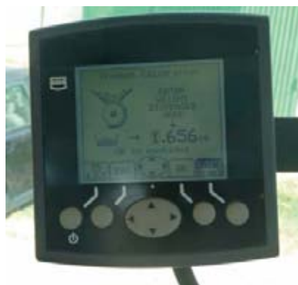
Foto 5. Sistema Genius Lite de control electrónico de los parámetros de trabajo de la sembradora.
