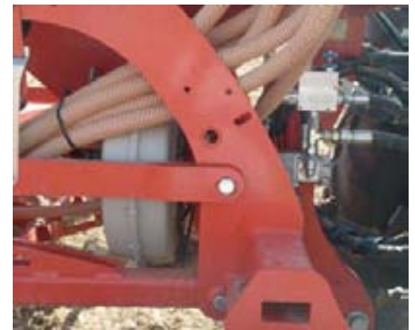
Foto 4. Accionamiento hidráulico de la turbina del sistema neumático.
