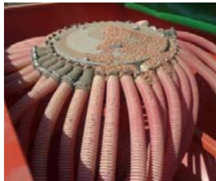
Foto 3. Sistema de distribución neumática con salidas individualizadas para cada cuerpo de siembra.
