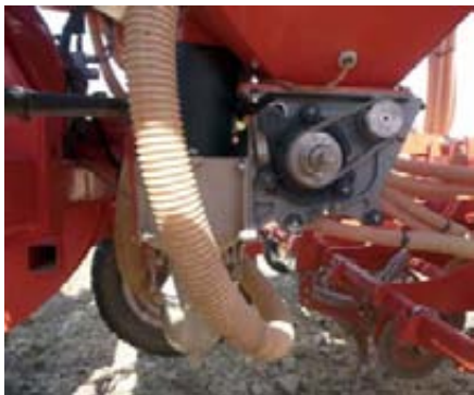
Foto 2. Sistema dosificador centralizado ubicado bajo la tolva.
