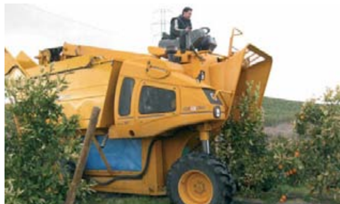
Prueba de recolección mecanizada con cabalgante Gregoire. Villarrasa (Huelva).
