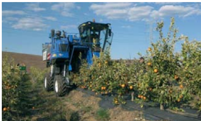
Prueba de recolección mecanizada con cabalgante New Holland. Villarrasa (Huelva).
