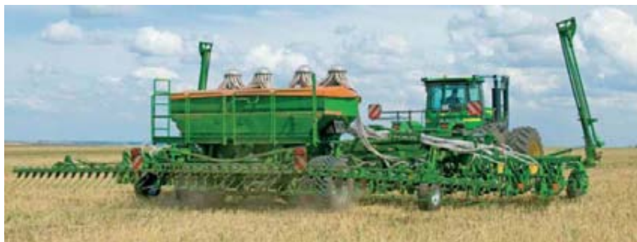
Sembradora directa con cuerpo de siembra abresurco de rejas montadas en un sistema de paralelogramo independiente.
