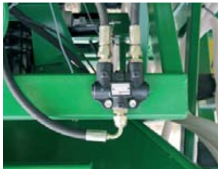
Válvula situada en el frente del bastidor de una sembradora, que se conecta al tractor por la tubería inferior y a los dos trazadores por las tuberías superiores, y alterna la subida y bajada de los trazadores.
