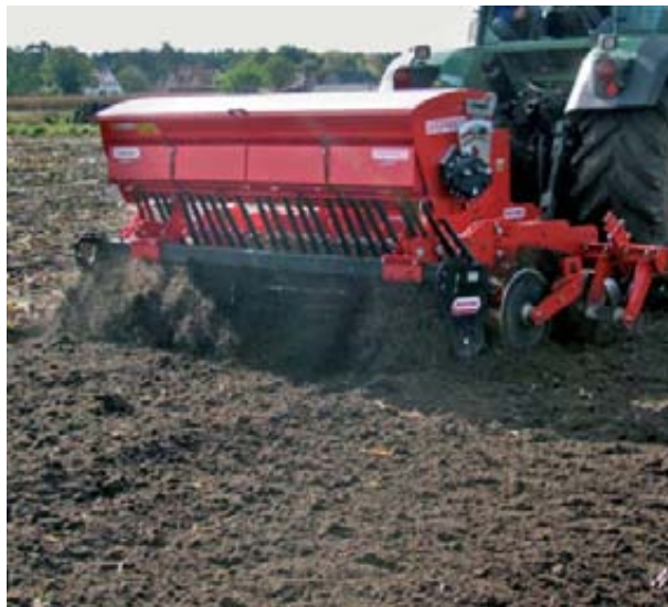
En las sembradoras sin transporte neumático, donde las semillas caen por su peso desde la tolva hasta los surcos, la tolva es ancha para alcanzar toda la anchura de trabajo de la máquina.
