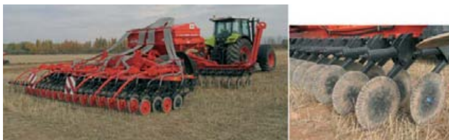
Sembradora para siembra sin laboreo previo y detalle de los discos que abren los surcos donde se depositan las semillas.
