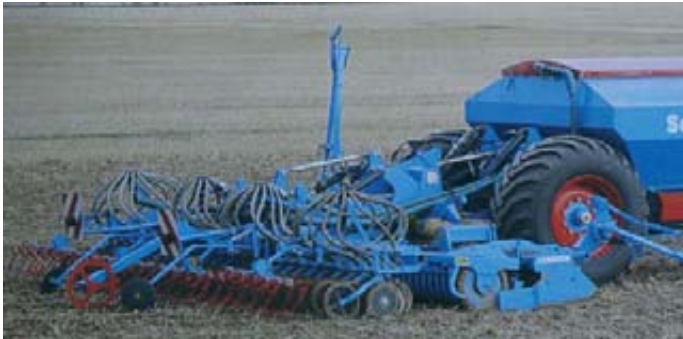
Sembradora a chorrillo neumática con los cabezales de distribución (cuatro) situados tras la tolva, sobre las rejas que abren los surcos.
