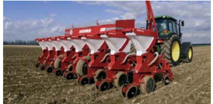
Sembradora monograno que permite sembrar hileras con alineación transversal en paralelo, al tresbolillo o con ajustes individuales de cada hilera.
