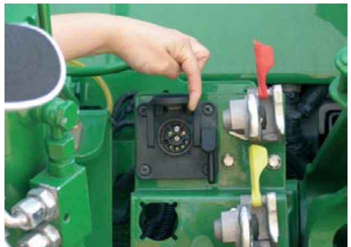
Foto izda. En la zona drcha, con tapa negra: tomacorriente convencional de 12 VDC (abajo) y conector Isobus (arriba). Foto drcha. Detalle de los contactos o patillas del conector Isobus.
