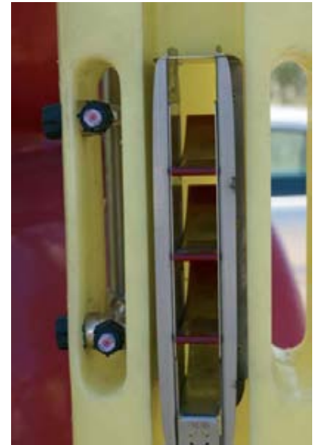
Foto 8. Detalle de las boquillas en una de las cinco salidas de aire dispuestas en cada bajante, con las respectivas lengüetas orientables.
