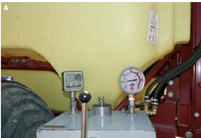
Foto 6. Establecimiento de la presión adecuada en el circuito. Izda (A). Verificación del manómetro del pulverizador por comparación con manómetro digital calibrado. (B). Ajuste de la presión del circuito. En caso de cerrar algunas boquillas los reguladores de la sección de paso (grifos naranjas en la parte inferior de la imagen) permiten ajustar el caudal a las necesidades reales, impidiendo que haya variaciones no controladas en la presión.
