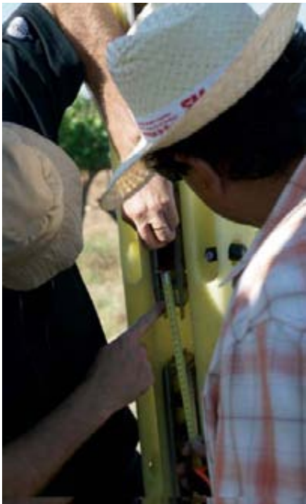
Foto 9 (izda.). Ajuste de las lengüetas deflectoras en cada salida de aire. Foto 10 (arriba). Verificación del régimen de giro de la turbina con tacómetro digital. Foto 11 (abajo, dcha.). Medición de la velocidad de aire en cada sección de salida mediante anemómetro y medidor de presión diferencial.
