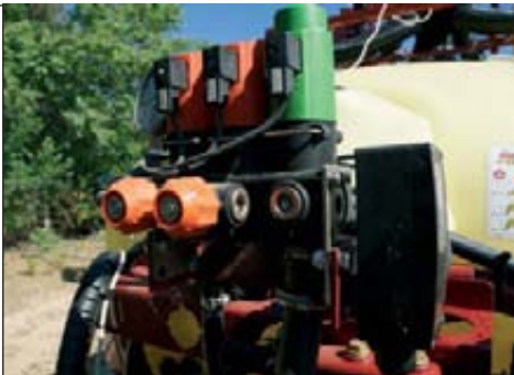
Foto 4. Distribuidor eléctrico CB/2 de alta presión, para mantener constante la presión en cada sector independientemente.
