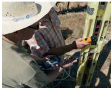
Foto 9 (izda.). Ajuste de las lengüetas deflectoras en cada salida de aire. Foto 10 (arriba). Verificación del régimen de giro de la turbina con tacómetro digital. Foto 11 (abajo, dcha.). Medición de la velocidad de aire en cada sección de salida mediante anemómetro y medidor de presión diferencial.
