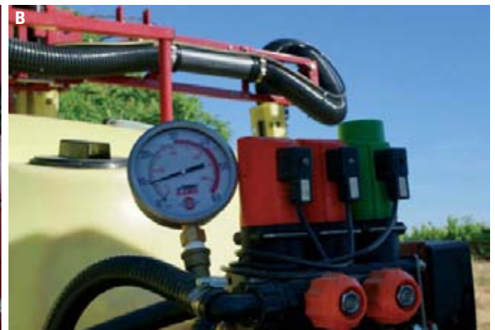
Foto 6. Establecimiento de la presión adecuada en el circuito. Izda (A). Verificación del manómetro del pulverizador por comparación con manómetro digital calibrado. (B). Ajuste de la presión del circuito. En caso de cerrar algunas boquillas los reguladores de la sección de paso (grifos naranjas en la parte inferior de la imagen) permiten ajustar el caudal a las necesidades reales, impidiendo que haya variaciones no controladas en la presión.
