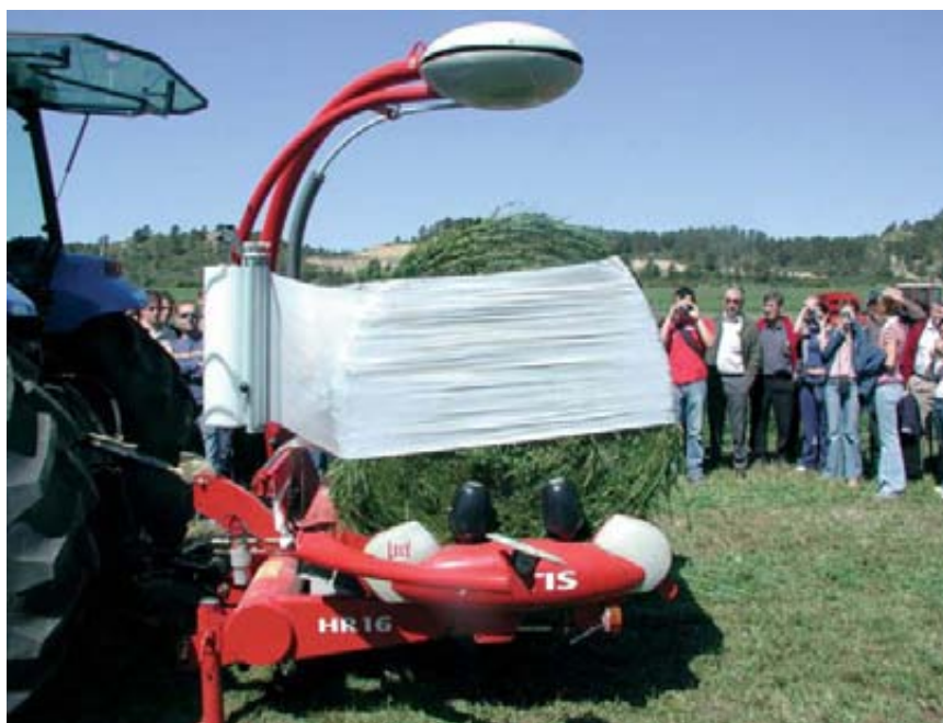
Foto 7 (izda.). Encintadora independiente. Foto 8 (dcha.). Empacadora-encintadora, que envuelve la paca en la cámara de empacado.
