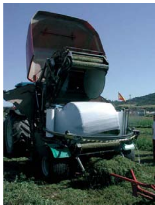
Foto 7 (izda.). Encintadora independiente. Foto 8 (dcha.). Empacadora-encintadora, que envuelve la paca en la cámara de empacado.
