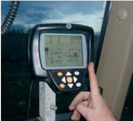
Foto 9 (izda.). Consola de mando con información y regulaciones de la empacadora.
