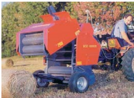
Foto 5 (izda.). Mini rotoempacadora de cámara fija. Foto 6 (dcha.). Mini rotoempacadora para pacas de 55 x 52 cm.
