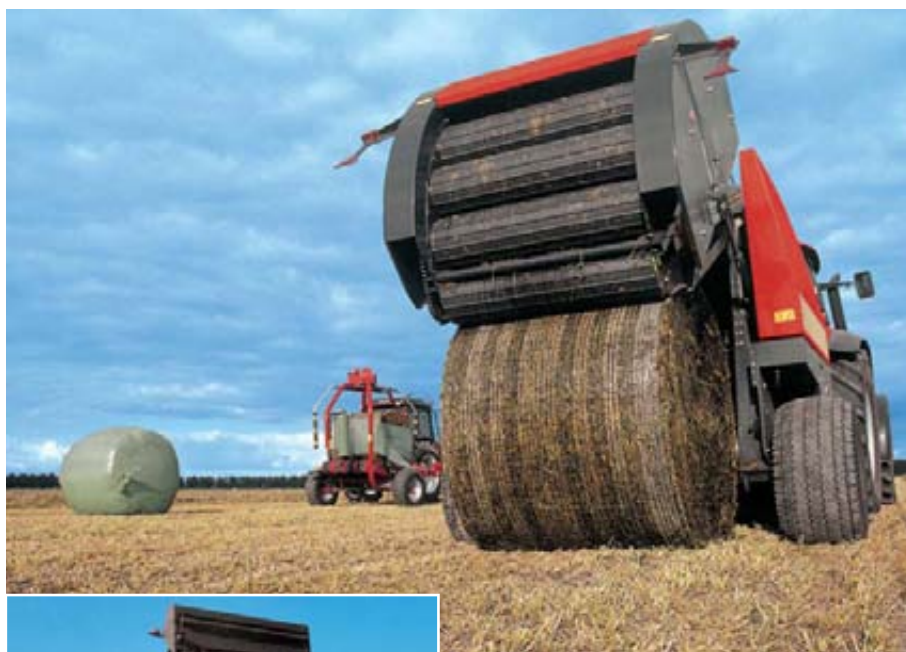
Foto 1 (arriba). Rotoempacadora de cámara fija. Foto 2 (izda.). Rotoempacadora de cámara variable.
