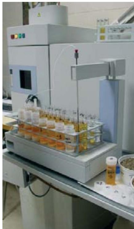
Análisis de muestras mediante ICP-AES.
