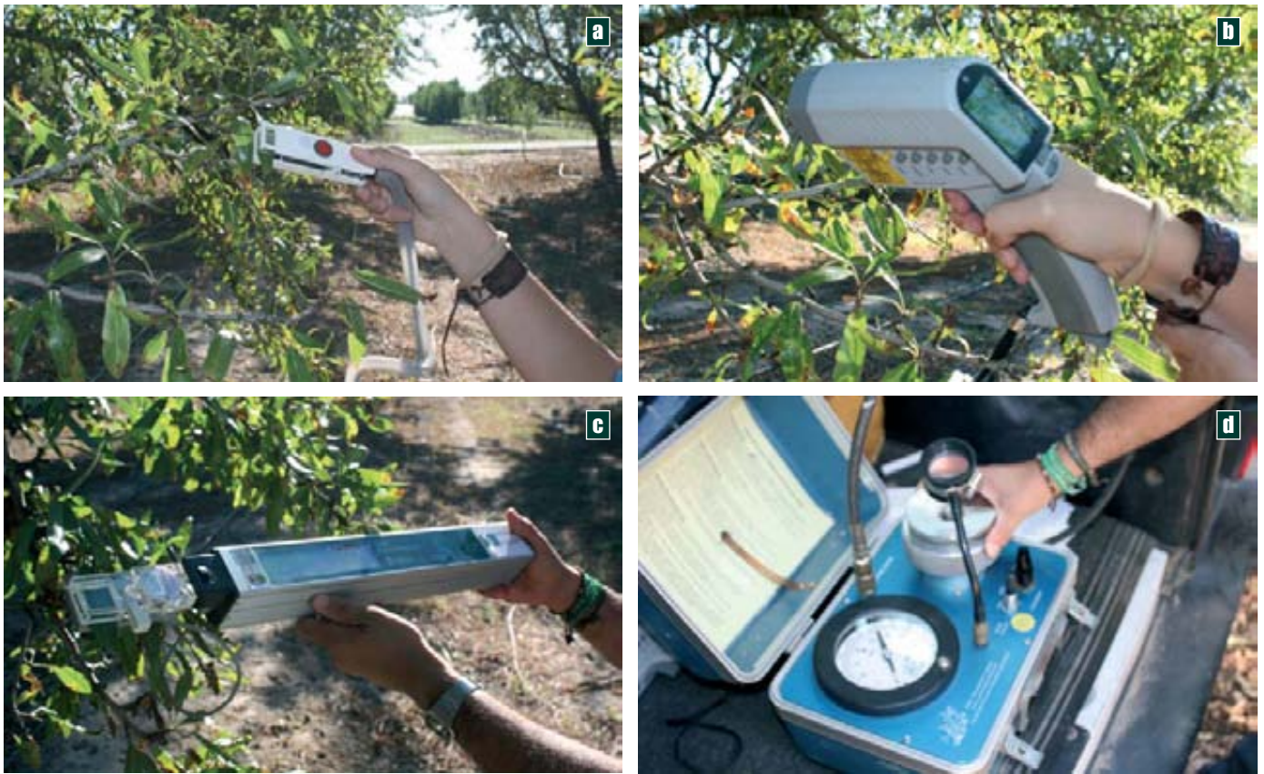
Foto 2. Medidor de conductancia estomática (A), termómetro de infrarrojos (B), actividad fotosintética (C) y potencial hídrico (D).
