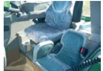
Foto 2 (arriba). Pruebas de conducción. Foto 3 (arriba, derecha). Nueva cabina VisioPlus. Foto 4 (abajo, derecha). Vista interior de la cabina: reposabrazos derecho con mandos y joystick, asiento Evolution Dynamic para el conductor y asiento supletorio para el acompañante.
