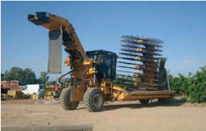
Foto 17. Cosechadora integral autopropulsada de cítricos con sacudidor de copa, plataforma de recepción y sistema de descarga en continuo a remolque.
