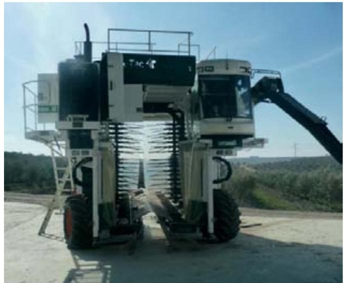
Foto 15. Sacudidor de copa lateral con plataforma de recepción en olivar intensivo. Foto 16. Sistemas sacudidores de una cosechadora cabalgante.
