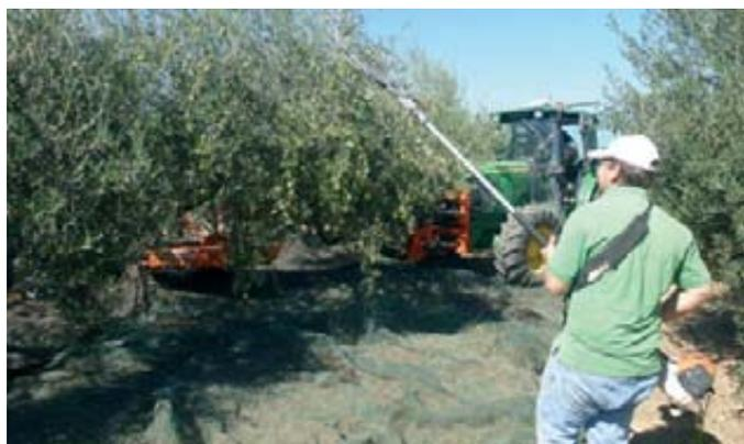
Foto 13. Vibrador autopropulsado con vareo de apoyo. Foto 14. Vibrador montado en un tractor con sacudidor de apoyo en recolección de aceituna de mesa.
