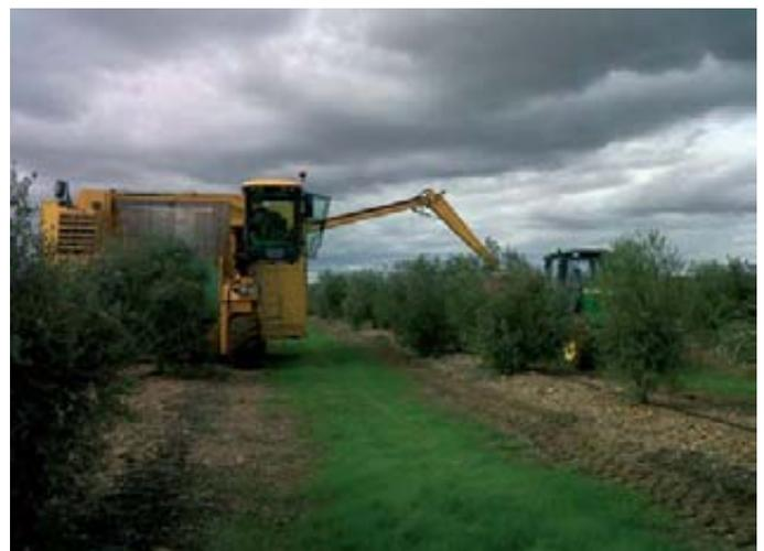
Foto 9 (foto izquierda). Cosechadora cabalgante para olivar intensivo con sacudidor de copa con movimiento pantográfico. Foto 10 (derecha). Cosechadora cabalgante para olivar intensivo con varios sacudidores adaptables a la copa.
