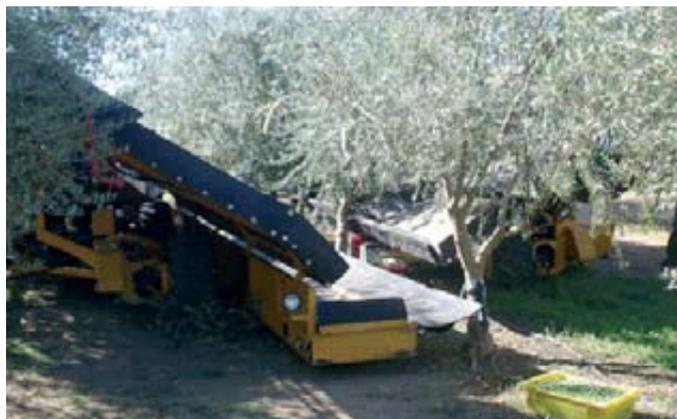
Foto 11. Conjunto de dos plataformas (derecha con vibrador, izquierda con tolva). Foto 12. Plataformas autopropulsadas trabajando en olivar intensivo.
