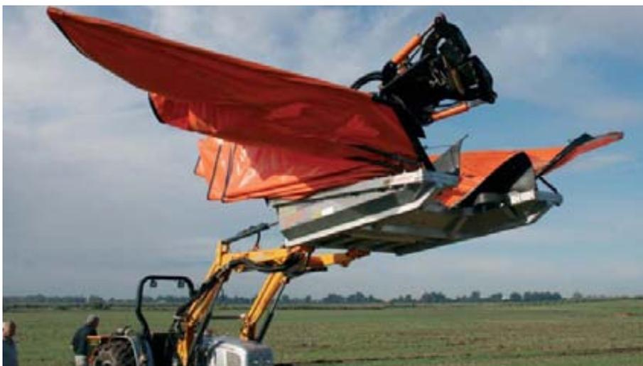
Foto 7. Paraguas con vibrador desplegándose.
