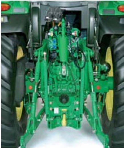
Foto 1. Vista trasera del tractor JD 6210 RE. En la parte superior de la imagen se pueden apreciar los dos tomacorrientes para servicios eléctricos externos. Fuente: John Deere.
