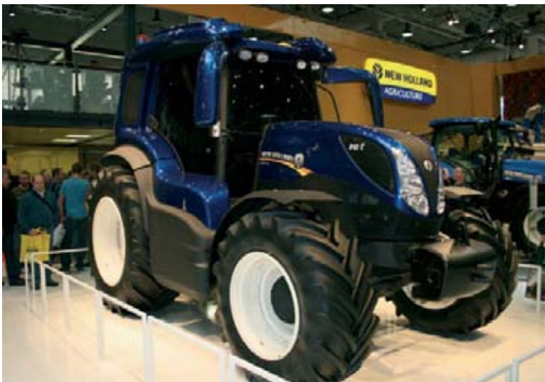
Foto 3. Tractor NH² de New Holland, con generador eléctrico de pila de combustible alimentada con H 2 . Presentado en la feria Agritechnica 2011.
