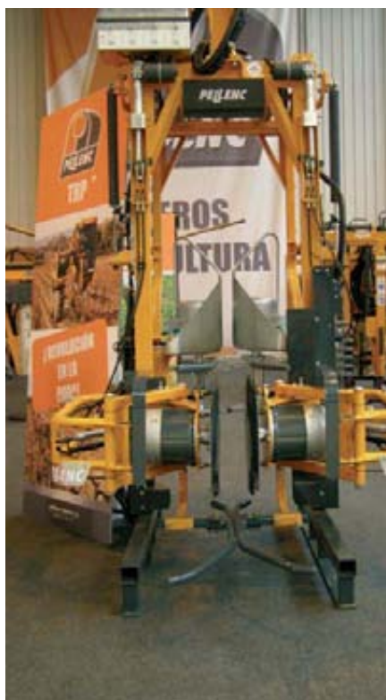
Foto 4. Cabezal de pre-poda para viña, montaje sobre vendimiadora. Observarse los discos de corte accionados por sendos motores eléctricos. Novedad técnica presentada por Pellenc Ibérica en FIMA 2010 (Zaragoza).
