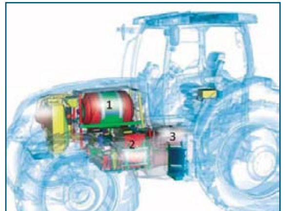
Foto 3. Tractor NH² de New Holland, con generador eléctrico de pila de combustible alimentada con H 2 . Presentado en la feria Agritechnica 2011.
