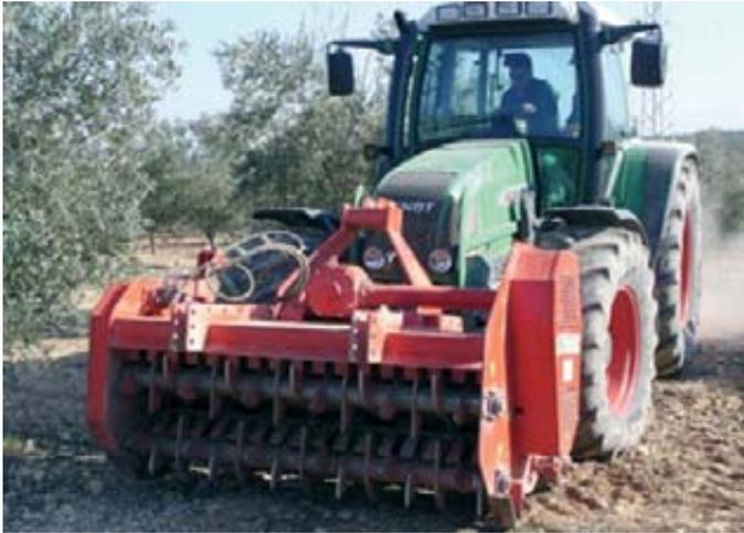
Foto 1. Tripuntal delantero y toma de fuerza accionando picadora de restos de poda.
