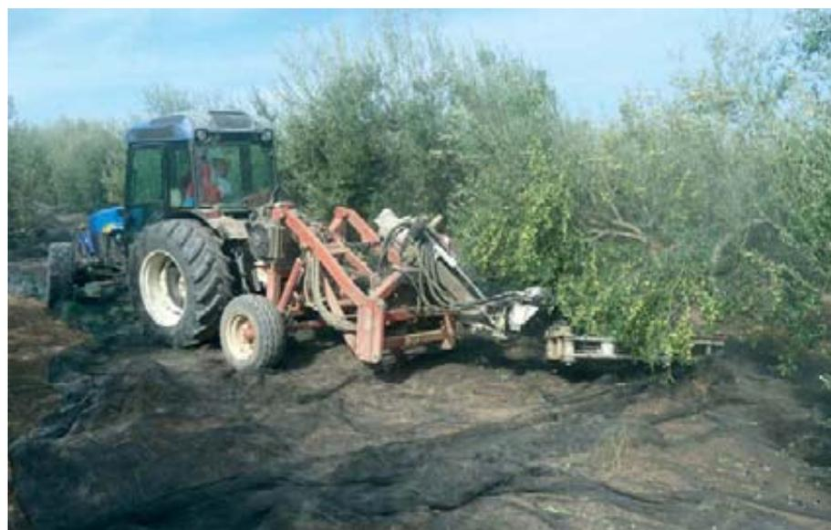
Foto 12. Tractor frutero con vibrador de troncos.
