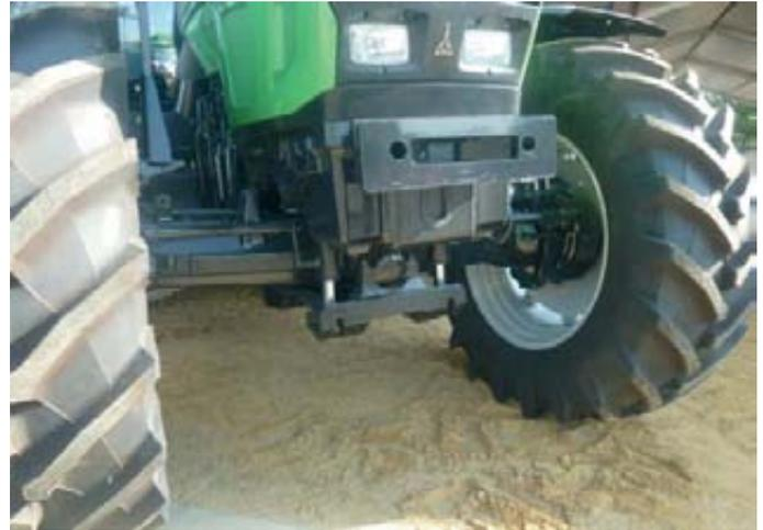
Foto 2. Suspensión del eje delantero.
