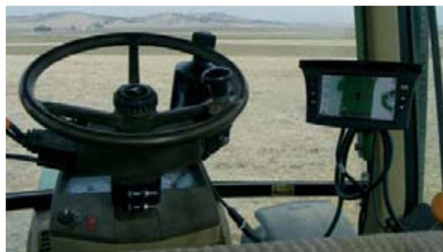
Foto 10. Sistema de orientación asistida con motor sobre el volante de la dirección.
