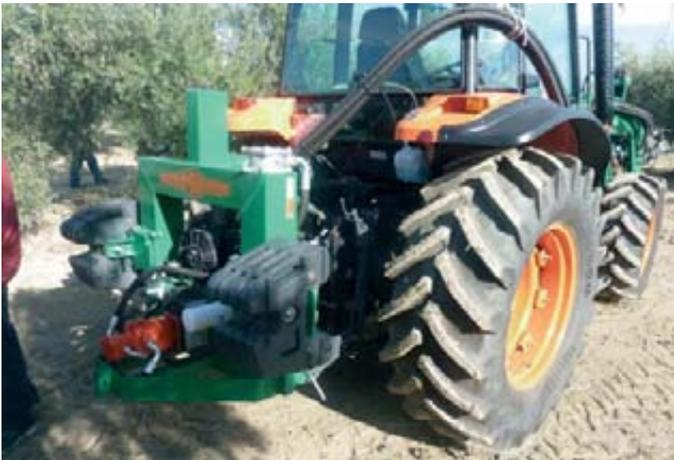
Foto 3. Neumáticos de alta flotación.
