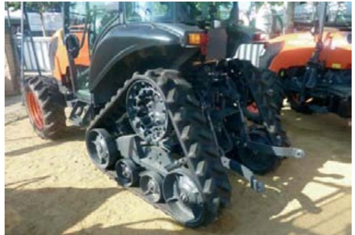
Foto 4. Sistema mixto neumático-cadena en un tractor frutero.
