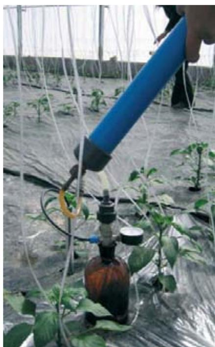
Utilización de bomba de vacío para succión en sonda de cerámica porosa en cultivo de pimiento.
