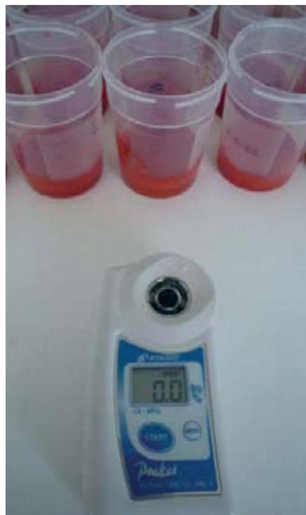
Refractómetro digital para determinación de sólidos solubles.
