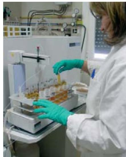
Foto 2. Análisis de muestras mediante ICP-AES.
