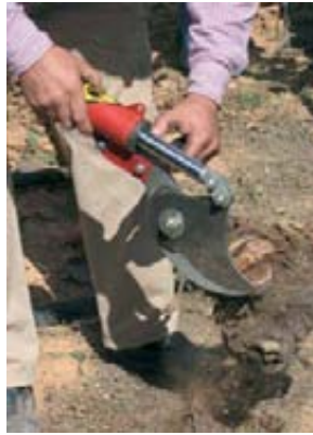
Foto 7 (izda.). Motosierra especial para poda de árboles frutales, cuya empuñadura está situada sobre el cuerpo de la máquina.
