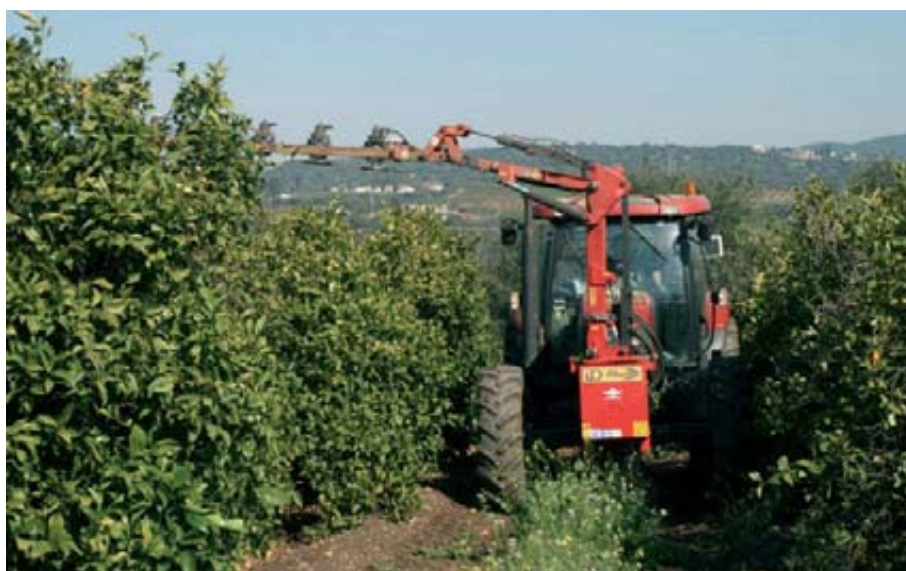
Foto 1. Barra con discos giratorios para poda de árboles.
