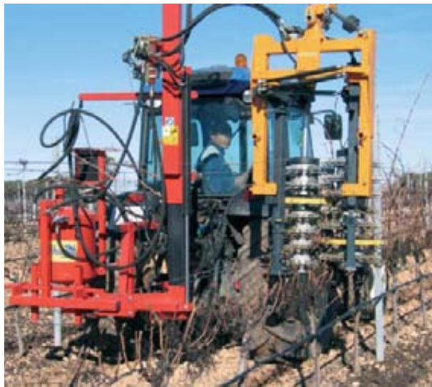
Foto 2. Prepodadora de cepas en espaldera a punto de llegar a un poste.
