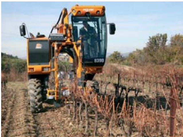
Fotos 3 y 4. Prepodadora de viña accionada con tambores eléctricos para una mayor velocidad de los mismos y por tanto del avance de la máquina.
