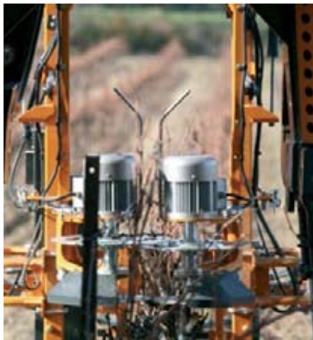
Fotos 3 y 4. Prepodadora de viña accionada con tambores eléctricos para una mayor velocidad de los mismos y por tanto del avance de la máquina.
