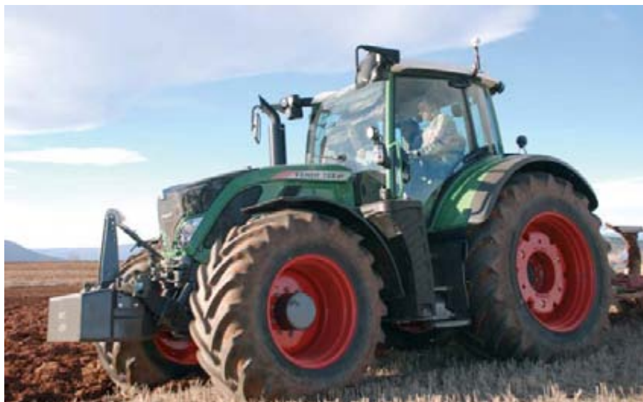
El Fendt 722 Vario mantiene el concepto de polivalencia, empleando un semi-bastidor adaptado a 240 CV capaz de dar consistencia sin penalizar el peso ni la batalla.
