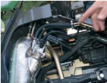
Sistema de inyección de AdBlue en los gases de escape.
