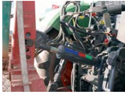
El elevador incorpora una varilla y un código de color reglado para facilitar visualmente al operario la regulación.
