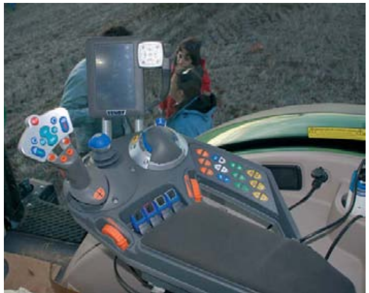
Reposabrazos del tractor, con la pantalla táctil y mandos de control.
