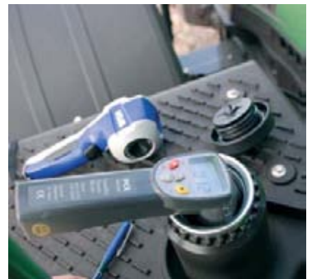
Medición de la temperatura del depósito de gasoil.
