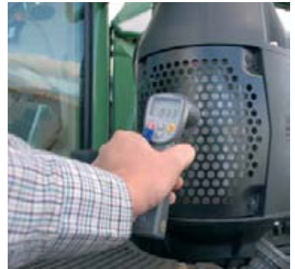
Foto izquierda: El buen comportamiento de las suspensiones y del bastidor en carretera permite circular a altas velocidades. Foto centro: Medición de la temperatura del neumático tras prueba de transporte. Foto derecha: Medición de temperatura en la chimenea de escape.
