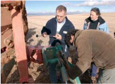
Foto izquierda: Regulación de la profundidad de trabajo de la labor con vertedera. Foto central: La prueba de campo se ha centrado en la evaluación de la respuesta del tractor Fendt 722 Vario durante una labor de arada con una vertedera Kverneland EG85 de cinco cuerpos bajo diversas estrategias de conducción. Foto derecha: Gracias al correcto reparto de pesos, el tractor se desenvuelve con grandes aperos suspendidos sin problema.
