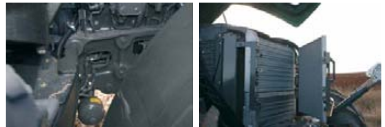
Detalle del bastidor delantero perforado, con las conducciones del hidráulico (izda) y acceso a los radiadores (drcha).
