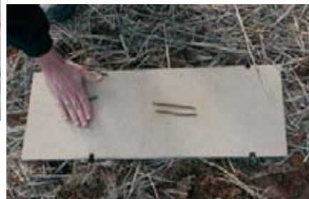
Realización de bastoncillos de suelo para verificar que se superaba el límite plástico.
