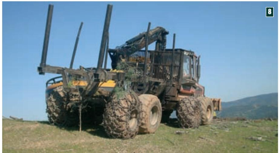
Foto 8. Neumáticos forestales de un autocargador equipados con cadenas antideslizantes en ruedas motrices.
