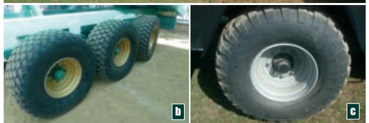
Foto 4. Neumático estrecho en tractor elevado. Foto 5. Neumáticos para ruedas arrastradas en diferentes máquinas agrícolas: (a) cultivador; (b) remolque tipo bañera; (c) empacadora (rueda de alta flotación).
