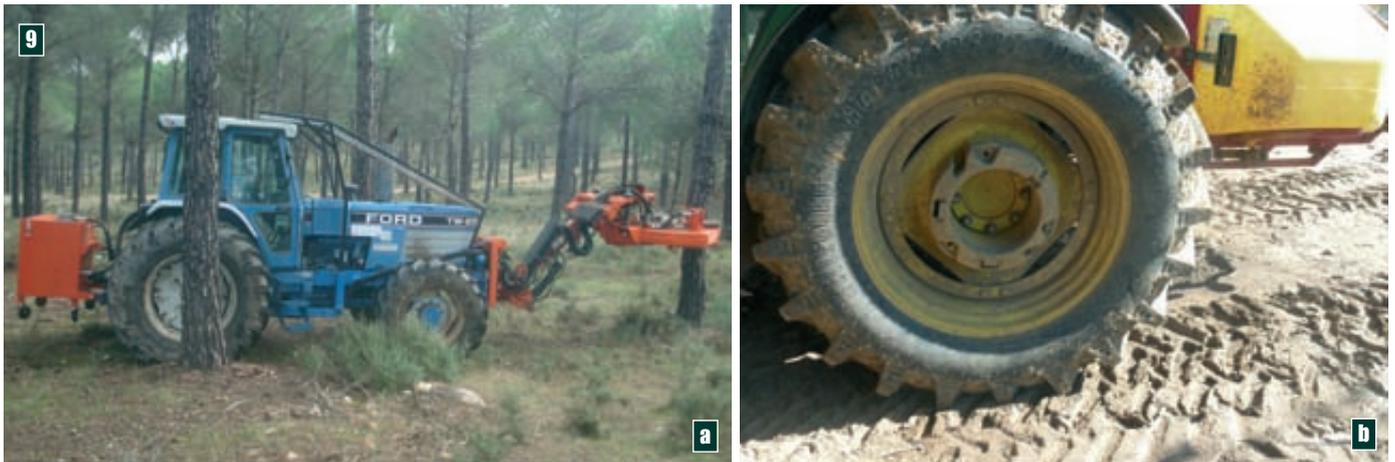
Foto 9. Tractores agrícolas en aplicaciones forestales: (a) con neumáticos agrícolas; (b) con neumáticos agroforestales.
