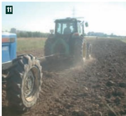
Foto 10. Marcado de un neumático (dimensiones 600/70 R 30). Foto 11. Disposición de los tractores durante el ensayo. En el primer tractor se observa el dinamómetro para medida de fuerzas en el enganche.
