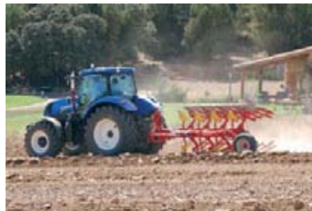
Vista del tractor T7.210 realizando la labor de arada y de la profundidad de arada con la vertedera.
