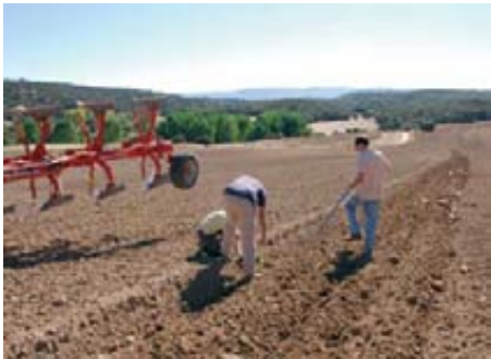
Tras la labor de arada, el equipo de pruebas verificó la profundidad de la labor, dato con el cual se ha podido conocer el consumo en ml por m 3 de suelo removido.
