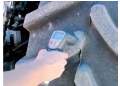
Medida de la temperatura de los neumáticos para comprobar el efecto del trabajo sobre los mismos.
