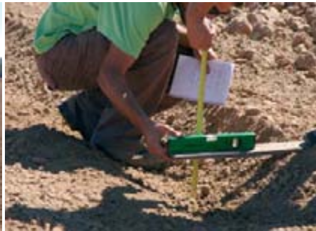
Tras la labor de arada, el equipo de pruebas verificó la profundidad de la labor, dato con el cual se ha podido conocer el consumo en ml por m 3 de suelo removido.
