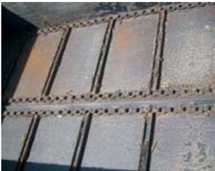
**Foto 8.** Fondo móvil de cuatro cadenas y perfiles en U.
