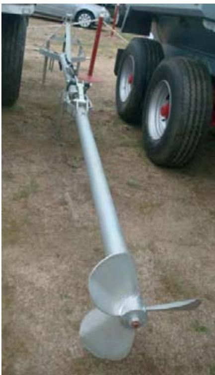
Foto 1. Agitador accionado por el tractor.
