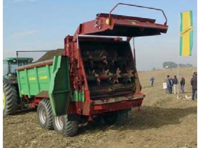
**Foto 6.** Detalles diversos: rejilla delantera, sistema de accionamiento (cilindro hidráulico) de la puerta posterior y sistema de avance (motor hidráulico) del fondo móvil. **Foto 7 (dcha.)**. Remolque con dos molinetes horizontales. Detalle de la puerta trasera y del accionamiento de los molinetes a través de cadenas.
