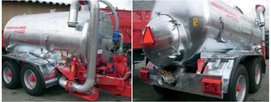
**Foto 15.** Elementos de una cisterna distribuidora de purín. Izda: sistema de aspiración-impulsión, brazo lateral de carga y eje doble en tándem. Drcha: sistema de distribución (boquilla).
