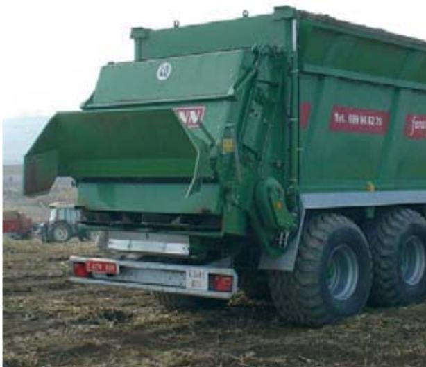
Foto 12 (arriba izda.). Dispositivo de esparcido en bordes. Foto 13 (arriba, dcha.). Remolque con distribución lateral. Foto 14 (dcha.). Remolque con equipo localizador delantero.
