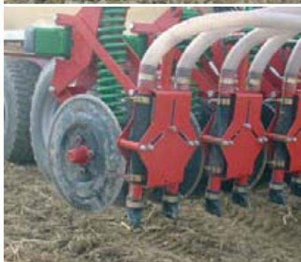
**Foto 21.** Arriba: cisterna con sistema de enterrado mediante discos simples. Centro: detalle de sistema: enganche, repartidor horizontal y discos. Abajo: detalle del sistema de conductos de salida del purín.
