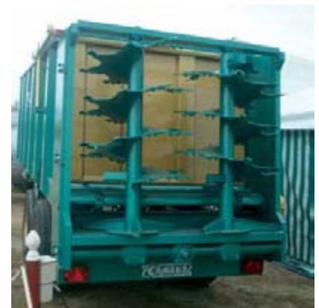
**Fotos 10 y 11.** Remolques con molinetes verticales y discos de esparcimiento. Izquierda: cuatro molinetes de dedos rectos; drcha: dos molinetes de cuchillas en espiral (tipo sinfín).
