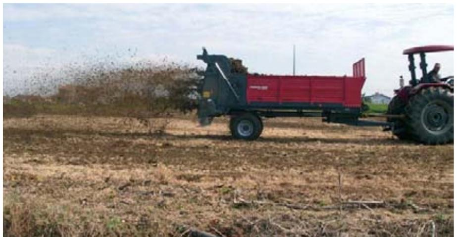
Foto 5. Remolque distribuyendo estiércol. Elementos: accionamiento a través de la toma de fuerza, caja y sistema de distribución.
