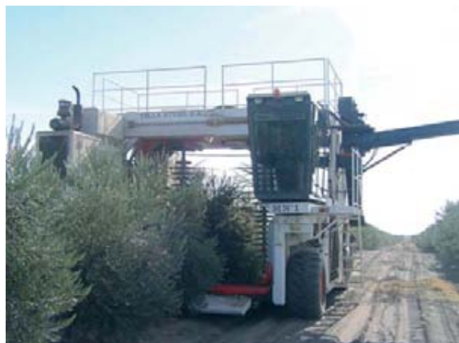
Foto izda. Cosecha de olivos intensivos mediante vibrador de tronco con paraguas receptor. Foto drcha. Recolectación con cosechadora en continuo en plantación de alta densidad.
