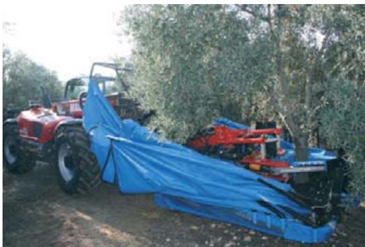
Foto izda. Cosecha de olivos intensivos mediante vibrador de tronco con paraguas receptor. Foto drcha. Recolectación con cosechadora en continuo en plantación de alta densidad.
