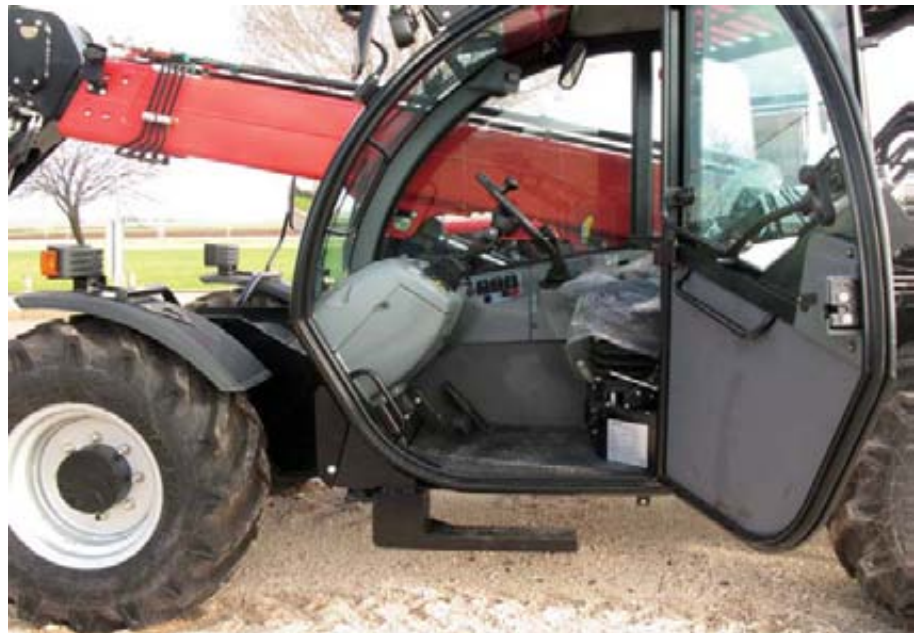
Cabina accesible desde el lado izquierdo a muy poca altura desde el suelo.
