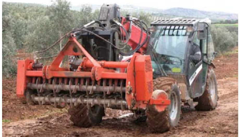
Faresin 7-30 Compact Olitract llevando una trituradora de restos de poda camino del tajo. Como el picado se produce por delante del vehículo, las ruedas nunca pisan las ramas antes de picarlas.
