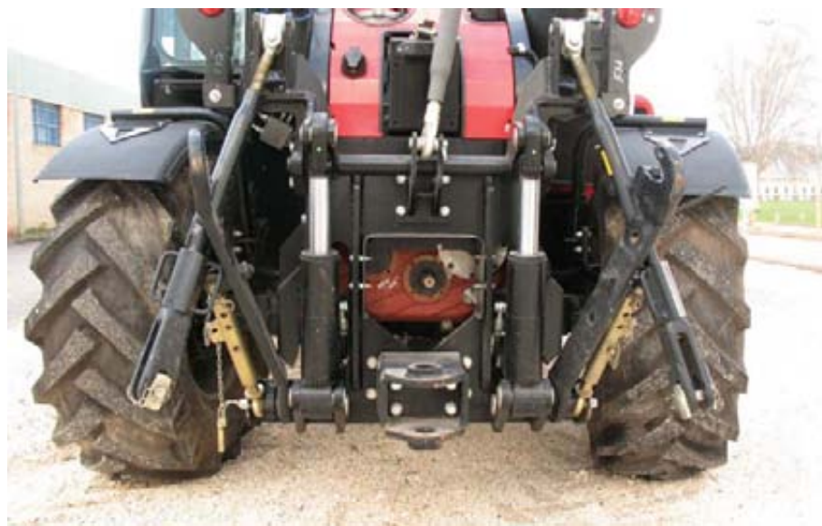
Vista trasera del vehículo Faresin 7-30 Compact Olitract con todos los elementos de acoplamiento de un tractor estándar. Obsérvense los dos fuertes cilindros para tener una gran capacidad de elevación de aperos suspendidos. Los brazos elevadores están plegados para transporte.
