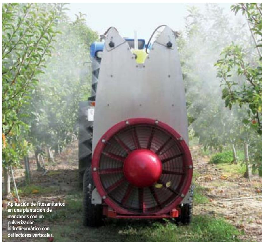
Aplicación de fitosanitarios en una plantación de manzanos con un pulverizador hidroneumático con deflectores verticales.
