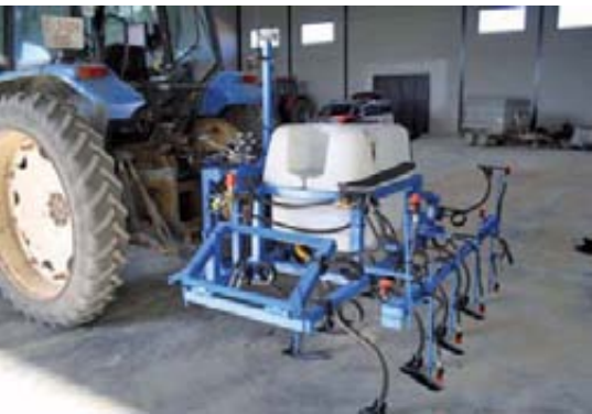
Foto 2. Equipo desarrollado para control optimizado de malas hierbas.
