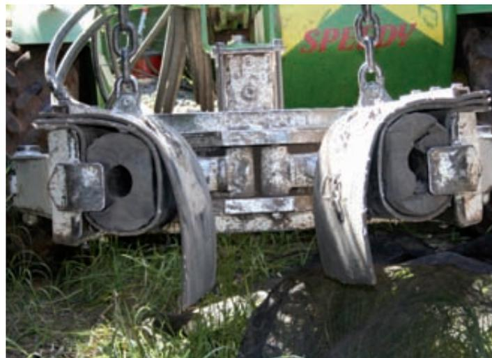
**Foto 9.** Vibrador de tronco para la cosecha de aceituna para aceite. Se está utilizando exitosamente aún en árboles de gran porte (hasta 5 m de altura) siempre que la poda sea adecuada para transmitir la vibración.
