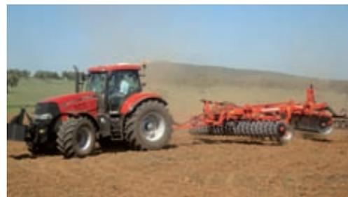
Foto 9. Tractor Puma 230 CVX y grada de discos en tándem Herculano modelo HXRP.
