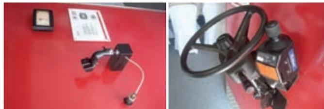
Foto 5. Elementos de la gama AFS: sistema de orientación asistida (izda) y monitor AFS Pro (drcha).
