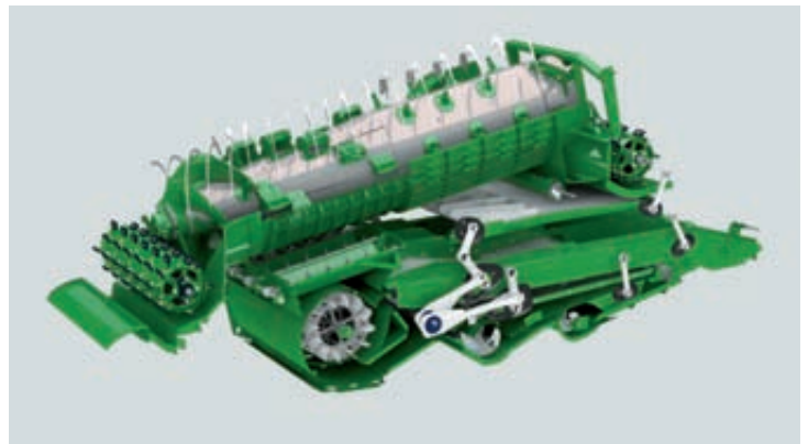
Fotos 11 y 12. Para la serie S, en esta campaña John Deere ha presentado un rotor optimizado, un sistema de retrilla activo y tapas ajustables del rotor, nueva caja de cribas y sistema de transporte de grano limpio, nuevas transmisiones y opciones de caja de cambios, entre otras modificaciones.
