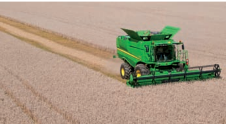
Fotos 11 y 12. Para la serie S, en esta campaña John Deere ha presentado un rotor optimizado, un sistema de retrilla activo y tapas ajustables del rotor, nueva caja de cribas y sistema de transporte de grano limpio, nuevas transmisiones y opciones de caja de cambios, entre otras modificaciones.
