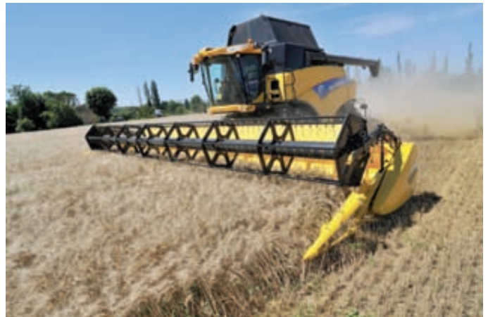
Fotos 13. New Holland ofrece la serie CR9000 con tecnología Twin Rotor: totalmente rotativa con doble rotor de gran diámetro (hasta 560 mm) dotados de segmentos de trilla en su parte delantera y dedos en la posterior.
