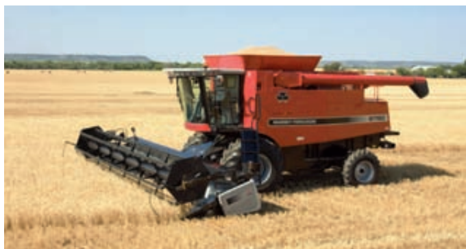
Fotos 9 y 10. Massey Ferguson apuesta por un único rotor de grandes dimensiones con cuatro sectores de adelante a atrás: carga, trilla, separación y descarga, sin necesidad de cilindro trillador ni cilindro lanzapajas trasero.
