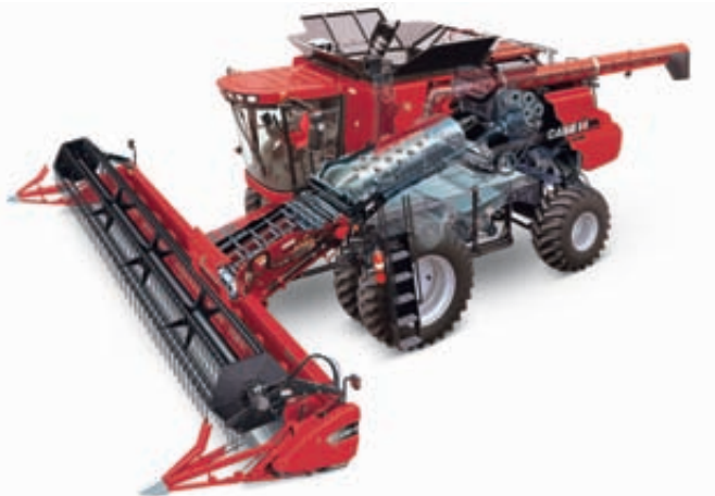
Fotos 1 y 2. Las Case IH Axial Flow son un excelente ejemplo de cosechadoras con tecnología de trilla y separación íntegramente por rotores.
