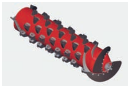
Fotos 3. El rotor de la serie Case IH Axial Flow está dotado de grandes aspas helicoidales en su extremo anterior, para encauzar el material impulsado por el alimentador y hacerlo girar alrededor.
