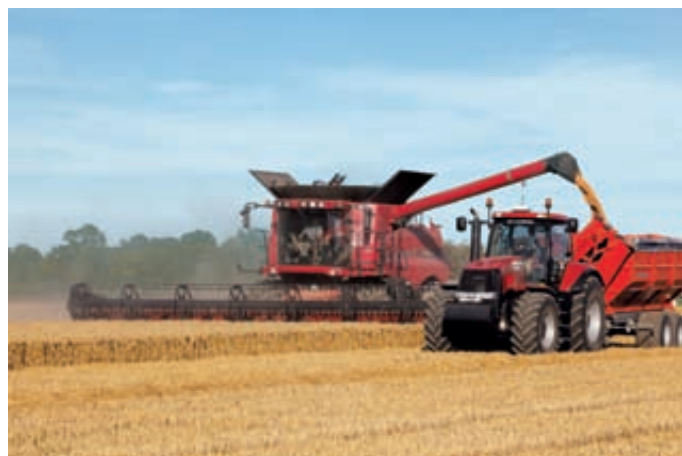
Fotos 1 y 2. Las Case IH Axial Flow son un excelente ejemplo de cosechadoras con tecnología de trilla y separación íntegramente por rotores.
