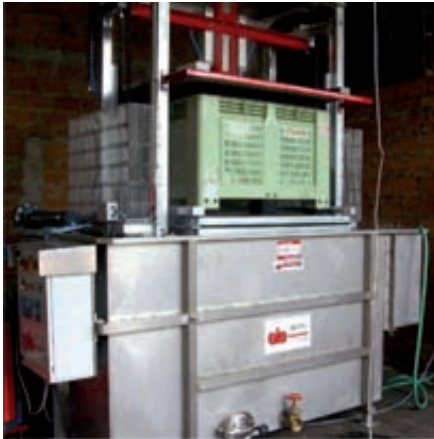
Equipo comercial para tratamiento de la fruta con agua caliente (bañado de palots; Xeda-Cedax).
