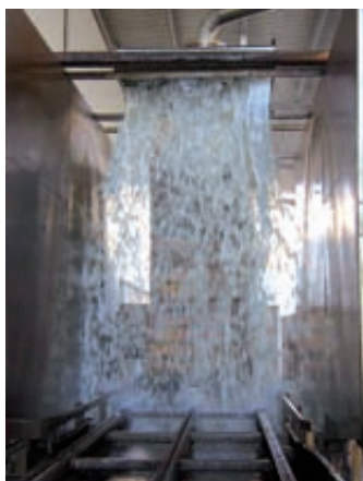
Equipo utilizado para el tratamiento postcosecha tradicional de fruta de pepita ( drencher ).
