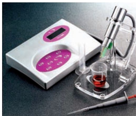
Equipo y reactivos para determinación enzimática de contenido de etanol en fruto.
