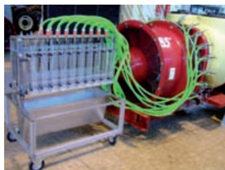
Ensayo del caudal de las boquillas.
