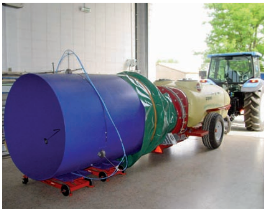
Ensayo del caudal de aire del ventilador.
