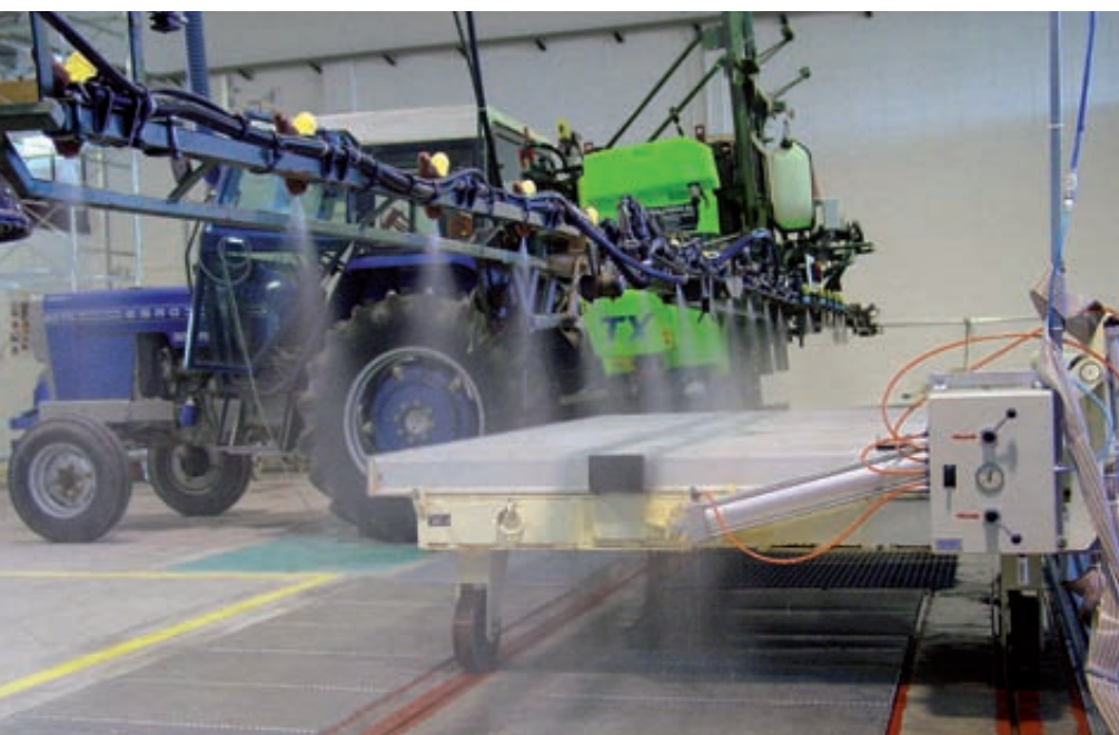
Banco de ensayo de la uniformidad de distribución de un pulverizador hidráulico.
