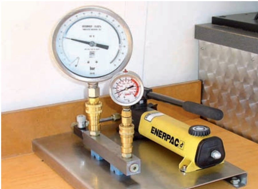
Contrastación del manómetro.
