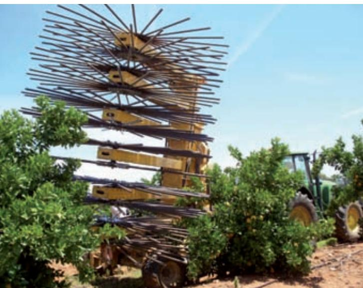
Foto 6. Sacudidor de copa (Oxbo, 3210) y tractor empleado en las pruebas de recolección mecanizada.
