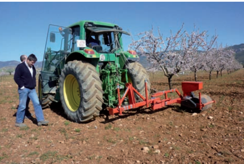
Foto 3. Prototipo de la máquina de aplicación de cebo rodenticida.
