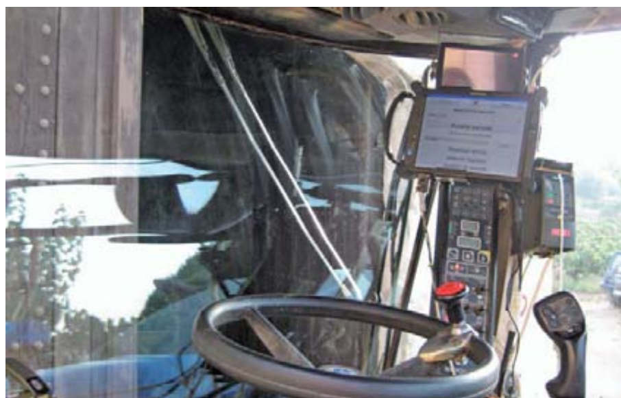
Monitor de rendimiento montado en un vendimiadora.
